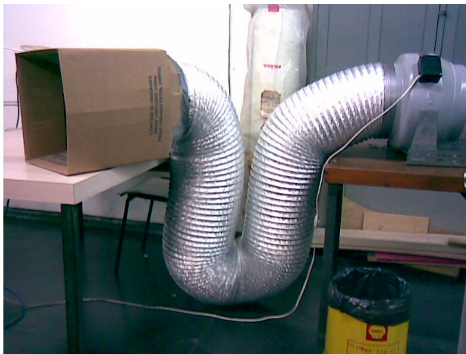
Fig. 6.14 - Vista geral do captor, duto e ventilador
